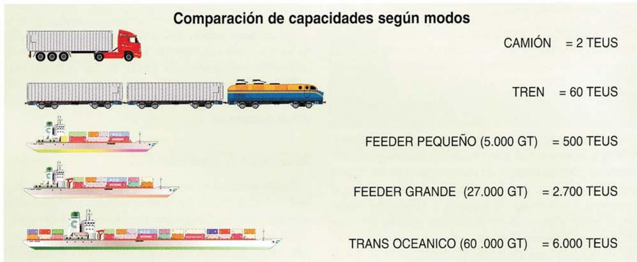
Figura 5. Capacidad de los distintos modos de transporte de contenedores.
